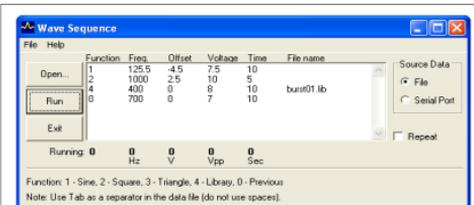
Ouvrez la fenêtre "Wave Sequence" sous "Tools" pour créer des formes d'onde automatiques provenant d'un fichier ou d'un port sériel.
