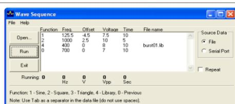
Abra la pantalla "Wave Sequence" bajo "Tools" para crear formas de onda automatizadas.
