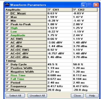
Öffnen Sie "Waveform Parameters", um ausführliche Parameter anzuzeigen.
