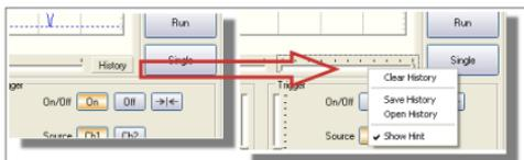
Pare el osciloscopio. Haga clic en "History" para abrir un menú. Guarde y abra el fichero con el resumen, y muévase con la rueda del ratón. Active el osciloscopio al hacer clic en "Run".
