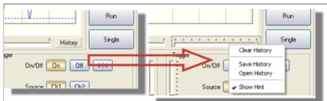
Stoppen Sie das Oszilloskop. Klicken Sie "History", um das Überlickmenü zu öffnen. Mit dieser Funktion können Sie bis zu 1.000 Signale festlegen. Öffnen Sie den Überblick und speichern Sie ihn, scrollen Sie mit dem Mausrad durch den Überblick. Starten Sie (drücken Sie "Run") das Oszilloskop aufs Neue.
